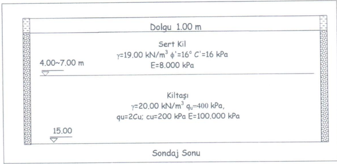
Şekil 4: Zemin Kesiti ve Geoteknik karakteristikler
